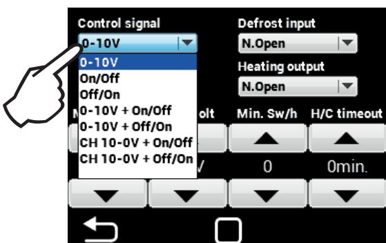
Options des signaux de commande:**0-10V** - contrôle du signal 0-10V**On/Off** - Commutation Marche/Arrêt**Off/On** - Commutation Arrêt/Marche**0-10V + On/Off** - Commutation Marche/Arrêt + contrôle signal 0-10V**0-10V + Off/On** - Commutation Arrêt/Marche+ contrôle signal 0-10V**CH 10-0V + On/Off** Commutation Marche/Arrêt+ 0-10V contrôle signal refroidissement 0-10V, chauffage 10-0V**CH 10-0V Off/On** - Commutation Arrêt/Marche + contrôle signal refroidissement 0-10V, chauffage 10-0V
